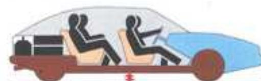
Sur les CX, grâce à la suspension hydropneumatique, la garde au sol reste constante quelle que soit la charge (dans la limite des poids autorisés).
